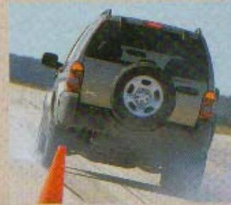
Vollbremsung aus Tempo 100 bei trockener Fahrbahn. Ähnlich wie bei der Naßbremsung liegen die Straßenreifen vorn. Ausnahme: der veraltete Fulda. Noch deutlich schlechter bremsen allerdings die groben von BF Goodrich und General.
